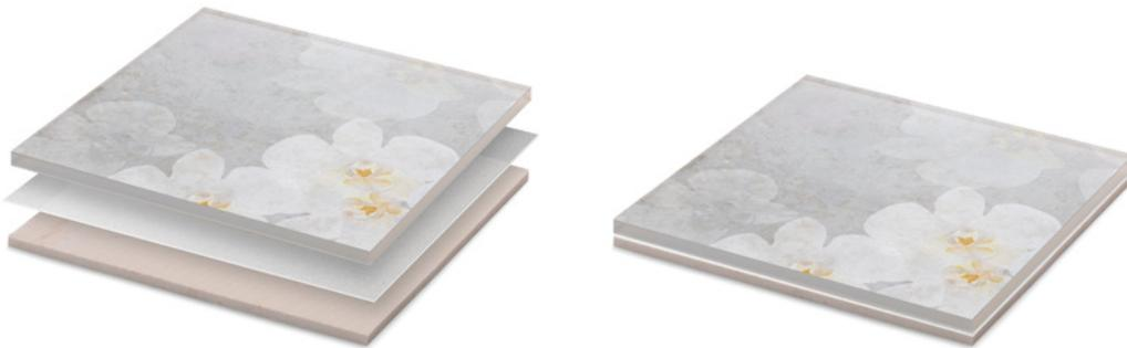
Rivestimento formato dall'accoppiamento di stratifica tra cristallo trasparente sp.5mm, decoro e ceramica sp.3mm, per uno spessore totale di circa 9mm. Glass nasce grazie alla tecnologia di incollaggio sottovuoto e in temperatura con uno speciale sigillante posto tra la lastra di ceramica e quella di cristallo creando un unico elemento resistente all'umidità e agli agenti chimici, dalle finiture superficiali personalizzabili. Il rivestimento è disponibile nei 3 decori:
