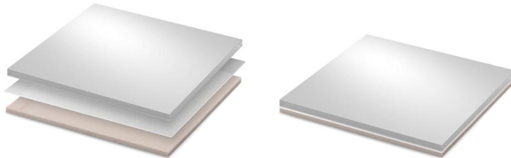
Rivestimento formato dall'accoppiamento di stratifica tra specchio sp.5mm e ceramica sp.3 mm, per uno spessore totale di circa 9mm. Glass nasce grazie alla tecnologia di incollaggio sottovuoto e in temperatura con uno speciale sigillante posto tra la lastra di ceramica e quella di specchio creando un unico elemento resistente all'umidità e agli agenti chimici, dalle finiture superficiali personalizzabili. Il rivestimento finitura SPECCHIO 02 è disponibile nel formato 100x100cm e su misura.
